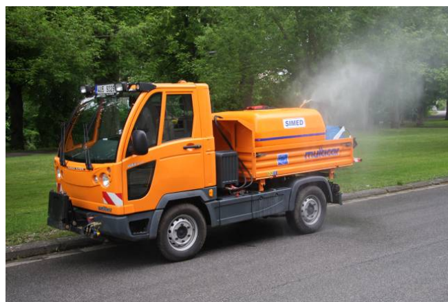
Hmlový systém – hmlová tryska sa nachádza na vrchu cisterny v zadnej časti
